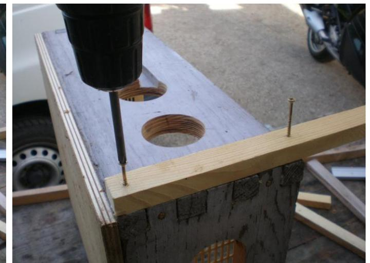
Une simple planche de contreplaqué de 5mm d'épaisseur, renforcée sur sa périphérie permet de réaliser un toit léger et suffisant qui ne devrait pas se déformer au fil du temps...
