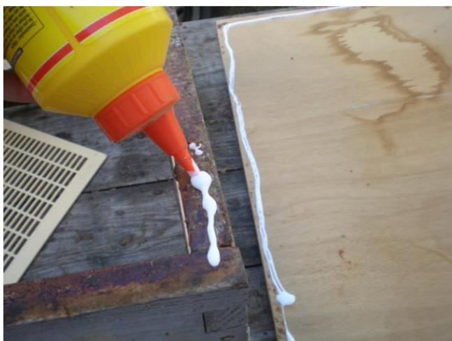
Colle à bois, encollage des deux pièces et mise sous presse...ou clouer !
