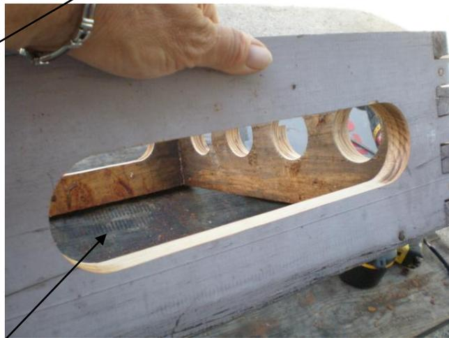
Sur les deux autres côtés, percer 2 trous espacés de 20 cm et les rejoindre à la scie sauteuse afin de créer une lumière de 26 cm de long
