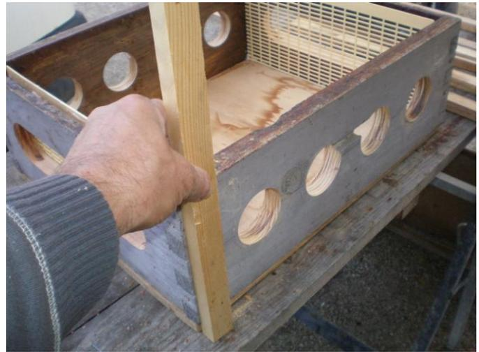
2 liteaux de 28 cm de haut de part et d'autre de la face arrière permettront d'obtenir une pente du toit de 20%.
